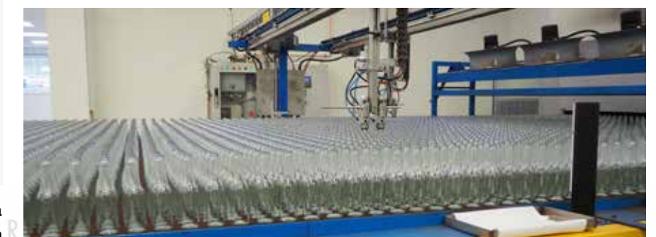
Kontrollen av det producerade glaset sker under ett stort antal säkerhetskontroller längs med hela processen. De glas som inte håller måttet kasseras och återvinns till ny glasmassa.
