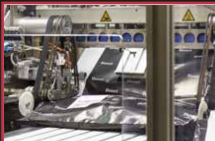
Serienpacker påsmaskin scannar ordersedeln, hämtar adressuppgifter från Booxts system och printar uppgifterna. Samtidigt som produkten omsluts med profilerade e-handelspåsar.
