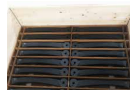
Specialformad innerförpackning med stötdämpande egenskaper som skyddar delarna under transport.
